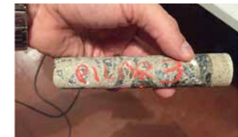
Imagem 13: Extração de minitestemunhos: exemplar extraído
