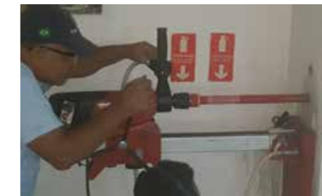
Imagem 12: Extração de minitestemunhos: uso da broca
