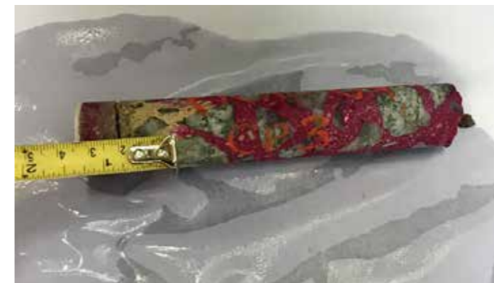
Imagem 14: Ensaio de Carbonatação: medição da profundidade carbonatada
