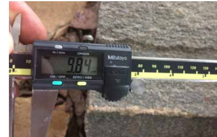
Imagem 3: Leitura da espessura do tubo no paquímetro
