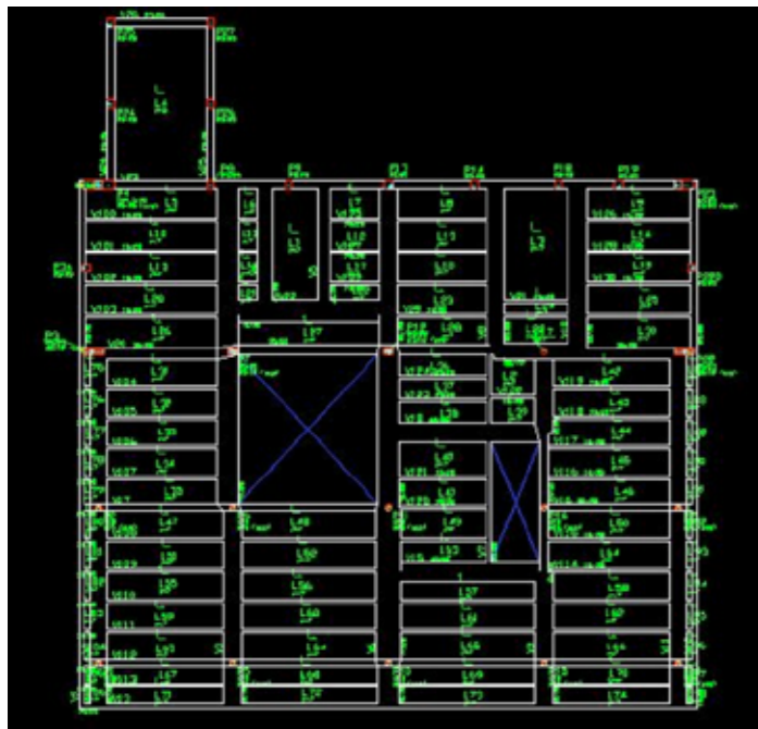
Figura 3: Modelagem do pavimento superior no software CAD/TQS
