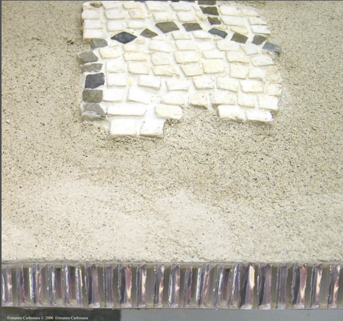
Panneau composé de nid d'abeille en aluminium entre deux couches de résine armées de fibres de verre
